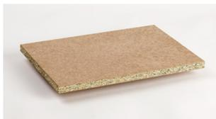
Tablero base madera, con caras de fibra e interior de partículas, de altas prestaciones y resistencia, clasificado como clasificado como tablero estructural clase técnica P5.
