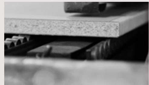
Las versiones SuperPan® Top y Star Top permiten realizar mecanizados de hasta 4 mm de profundidad.
