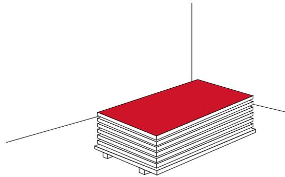
original o muy similar y evitar todo ambiente húmedo para preservar sus propiedades físico-mecánicas en óptimas condiciones.
