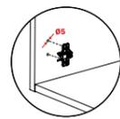
Mecanizados de Ø5 mm para bisagras
