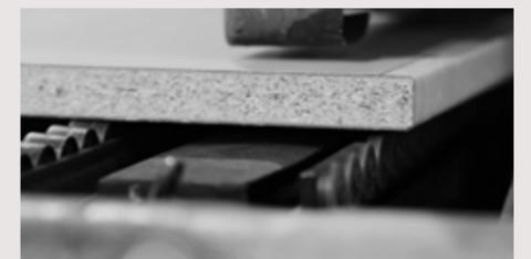
Les versions Superpan Top et Superpan Star Top permettent des profondeurs d'usinage allant jusqu'à 4 mm.
