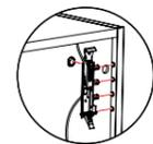
Usinage pour suspensions invisibles
