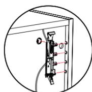
Mecanizado para ferragem de gancho oculto
