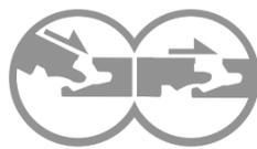
Las tablillas del suelo laminado se fijan entre sí sin necesidad de colas u otros elementos externos. Se trata de un ingenioso sistema que, mediante el fresado de los cantos de las tablas, permite que estas se encajen como si fueran las piezas de un puzzle. Este sistema de **fijación sin adhesivos**, llamado "clic", permite que el suelo laminado pueda instalarse prácticamente **sobre cualquier material** (cemento, madera, azulejo, cerámica...) sin necesidad de fijarlo al pavimento existente.
