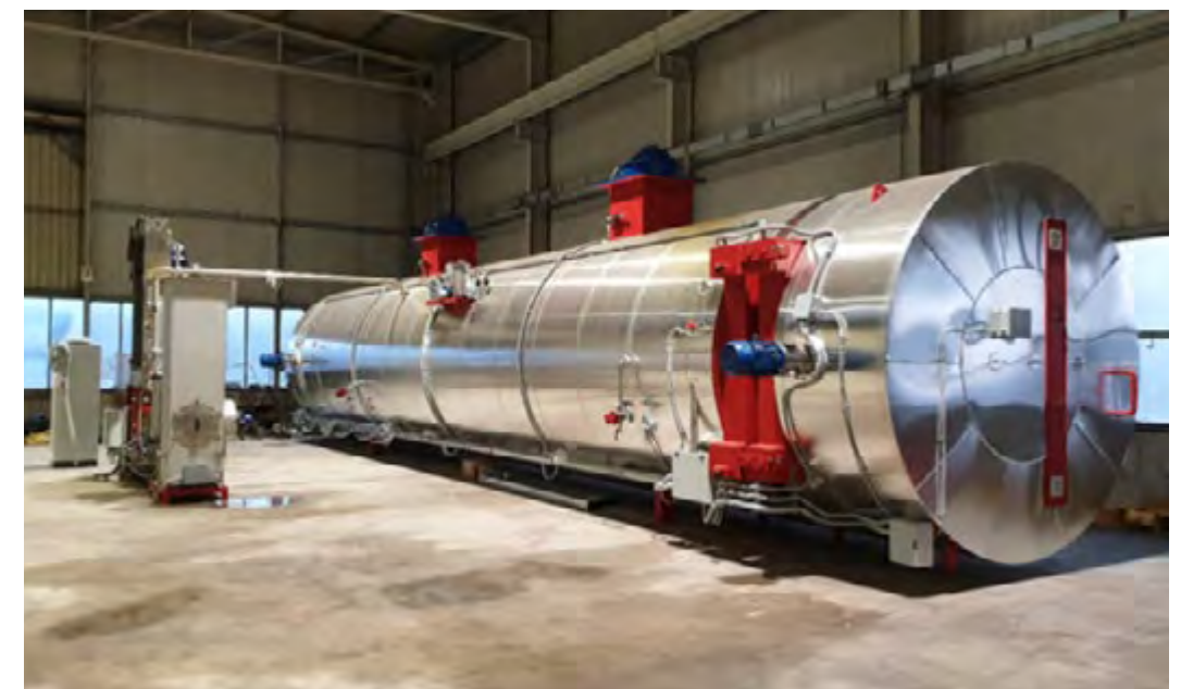
Câmara de tratamento térmico
