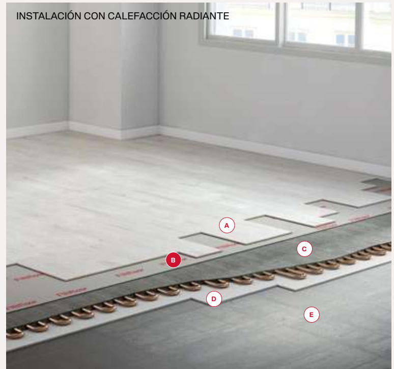
A FINFLOOR B MANTA SILENT ELITE FINFLOOR C CALEFACCIÓN RADIANTE D AISLANTE E SOLERA
