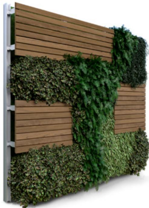
El anclaje del módulo de madera a la estructura de VP Módulo es mediante dos herrajes fijados en los extremos del panel. Cada herraje dispone a su vez de dos puntos de anclaje que permiten colgar el módulo a la estructura. La colocación del conjunto se lleva a cabo de abajo a arriba, de manera que el último módulo se puede bloquear con una pieza metálica bloqueando a su vez los módulos inferiores
